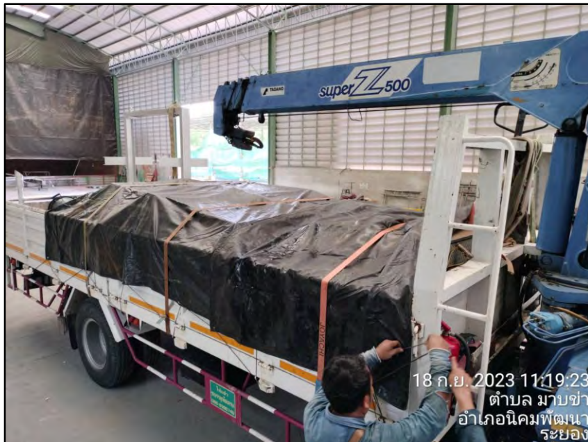
ภาพตัวอย่างการรัดติดตรึงชิ้นงานกับรถเฮียบ
